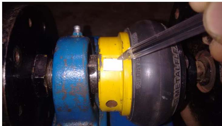
Figura 4 - Aplicação da fita refletiva no acoplamento
